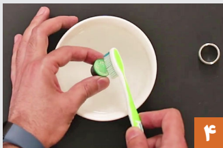
آیفشان را در درون محلول رقیق آب و سرکه قرار داده و با مسواک تمیز کنید
